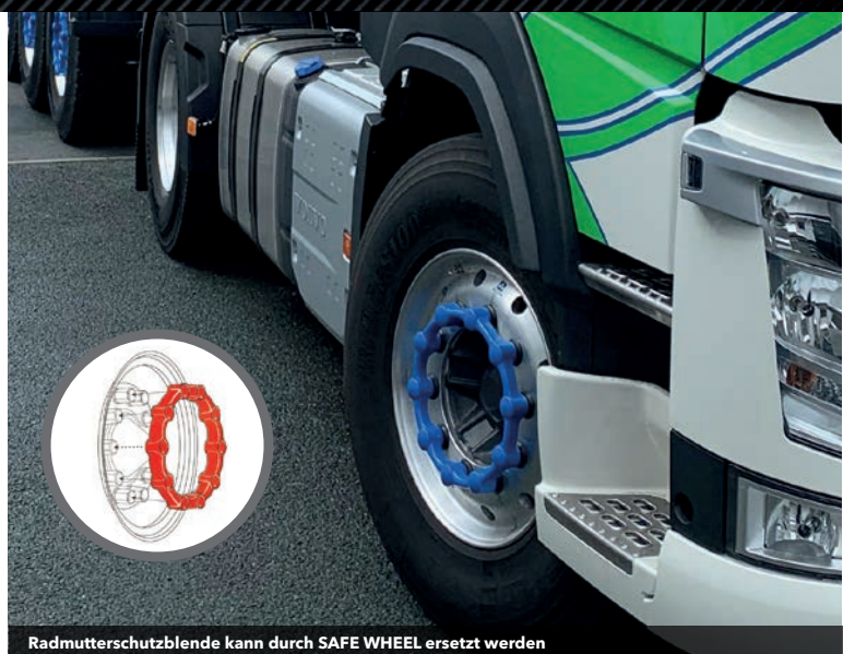
Radmutter Schutzblende kann durch SAFE WHEEL ersetzt werden
